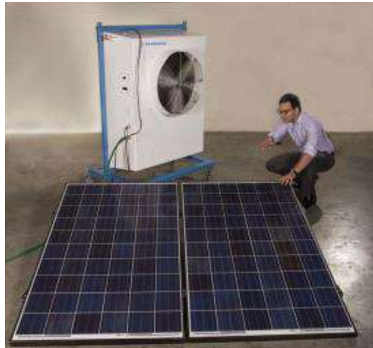
Figura 54. Sistema de refrigeración autónomo mediante enfriamiento evaporativo
