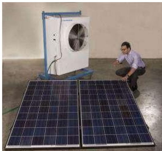
Figura 54. Sistema de refrigeración autónomo mediante enfriamiento evaporativo
